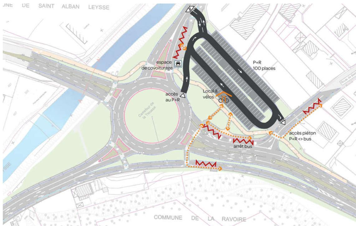
La création du giratoire à quatre branches va nécessiter la reconfiguration du parking relais de la Trousse.
